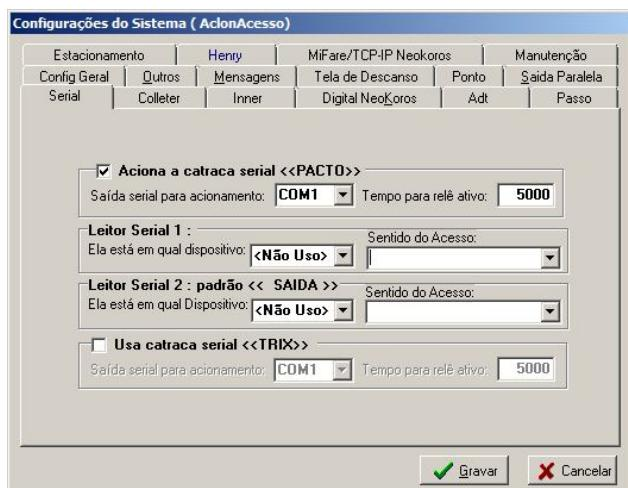
Na aba serial deve-se habilitar a opção “aciona catraca serial Pacto”. No campo “Saída serial para acionamento” escolher a opção serial em que a catraca está conectada. (Ex: COM1, COM2.) E o tempo para relê ativo é a quantidade de tempo em milissegundos que a catraca ficará liberada.
